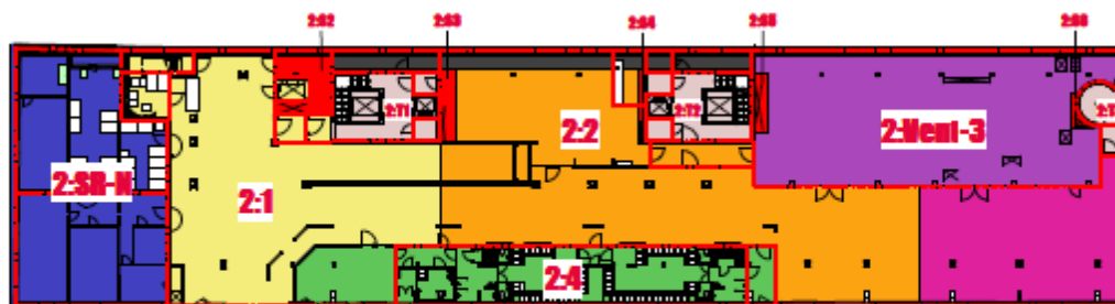
'Taktplan' från Nattugglan – indelning per våning och zon för produktionsplanering och logistik
